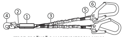
СТРОП ДВОЙНОЙ С АМОТИЗАТОРОМ АKN44
