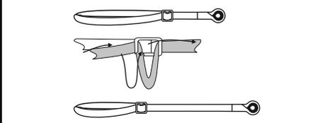
Рис. 8. Ограничения по использованию стропов с амортизатором
