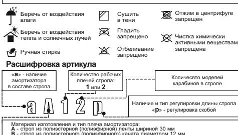
Материал изготовления и тип плеча амортизатора:
