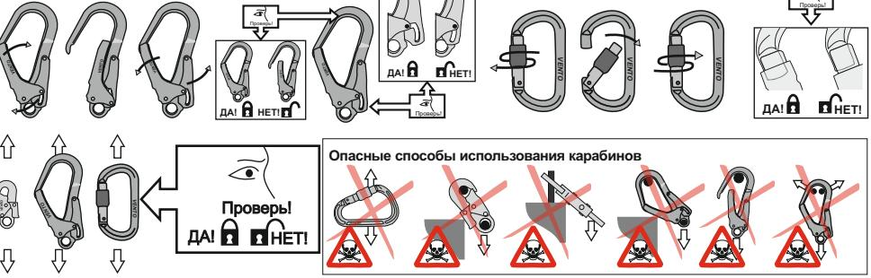
Рис. 7. Способы крепления стропов к анкерным устройствам
