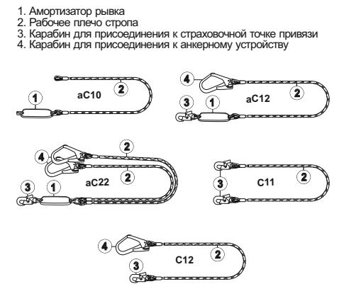
Рис. 4. Использование карабинов, входящих в комплектацию стропов
