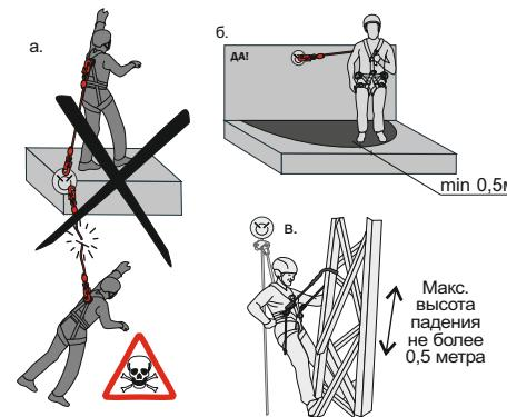
Рис. 10. Способы крепления стропов к анкерным устройствам
