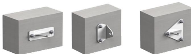
Вариант установки стационарных концевых анкерных точек к бетонной поверхности.
