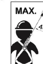
Максимальный угол отклонения от анкерной точки крепления СЗВТ
