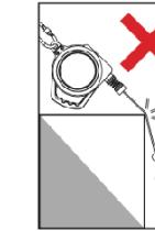
Запрещается эксплуатация СЗВТ в контакте с острыми кромками
